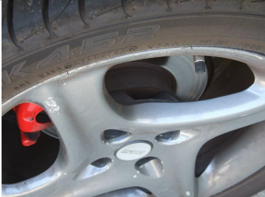
Solleviamo la vettura. Evitiamo di lavorare lasciando sollevata la vettura con con il crick...utilizziamo appositi cavalletti. Prima di sollevare la vettura allentiamo le viti filettate delle ruote.
