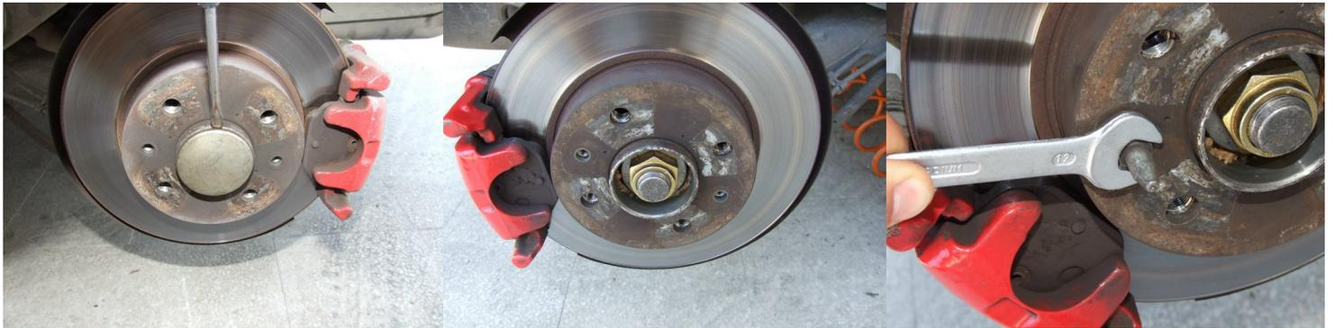
Diamo una leggera carteggiata alla superficie del mozzo...operazione necessaria per la fase di verniciatura...
