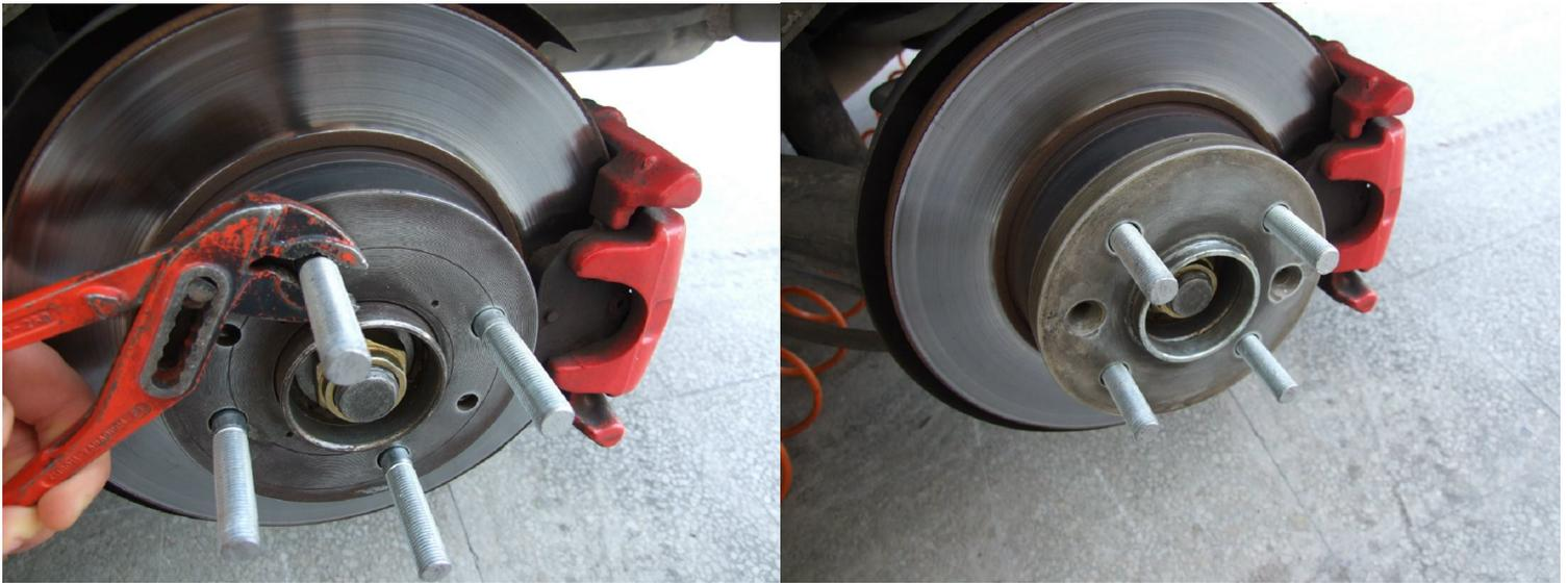
Premontiamo il cerchio verificando che la lunghezza delle colonnette sia corretta. Per colonnette e dadi a filettatura passante la lunghezza della colonnetta deve essere la lunghezza della vite originale con aggiunta dello spessore del distanziale. Per dadi ciechi (come quelli da me montati) il calcolo della lunghezza della colonnetta deve tener conto della profondità della filettatura del dado cieco.
